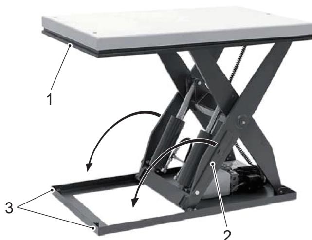
Fig. 7: Protection contre tout affaissement involontaire
