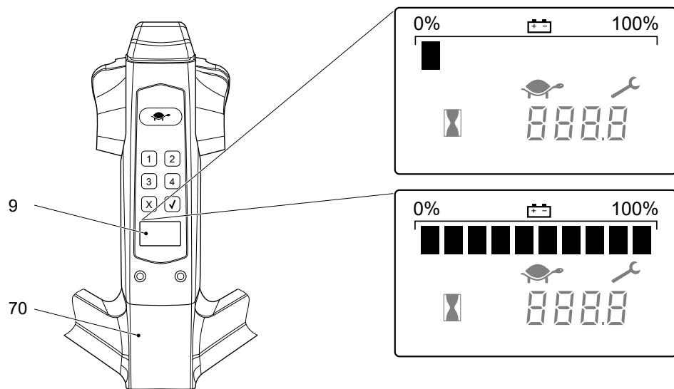
Die Ladezustandsanzeige der Batterie ist in die Anzeigeeinheit (9) auf dem Deichselkopf (70) integriert.
