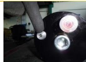
2. Verstellbolzen aus dem Pumpenhebel (4 Bohrungen) entfernen
