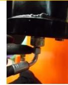
Schlauch (Werkzeug: Ringschlüssels – Gr.22) von der Pumpe lösen. Dabei können geringe Mengen Öl auslaufen, die durch einen Lappen oder kleines Gefäß aufgefangen werden sollten.
