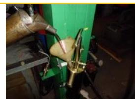
4. Öl einfüllen – hierzu Öleinlassschraube entfernen und mit Hilfe eines geeigneten Trichters o.ä. neues Öl bis zur Markierung einfüllen und Öleinlassschraube wieder eindrehen und anziehen!
