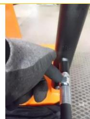
**Sollte es eine Undichtigkeit an der Ölablaßschraube geben, reicht der Austausch dieser Schraube:**
