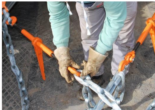
Die textile Kette auf die benötigte Länge verkürzen und mittels Sonderlastspanner spannen.
