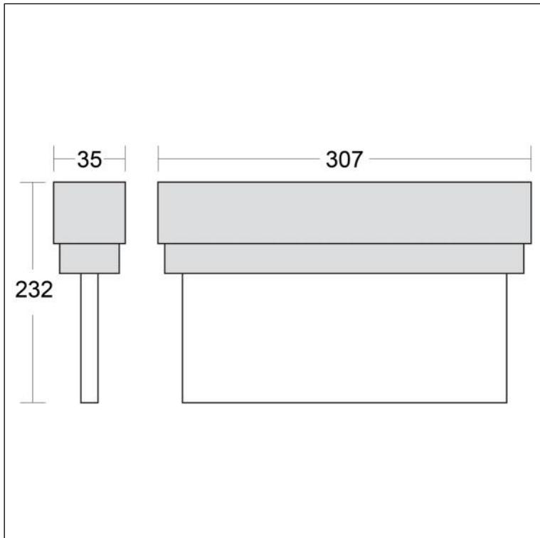
Formschöne und moderne LED-Scheibenleuchte für universelle Montage, als Einzelbatterie-Scheiben-Notleuchte mit AUTOTEST-Funktion, Signalisierung über 1x mehrfarbige LED, inklusive Prüftaster, gemäß DIN EN 60598-1, DIN EN 60598-2-22, DIN EN 62034 und DIN EN 1838 für Anlagen gemäß DIN VDE 0108, zum separatem Betrieb.
