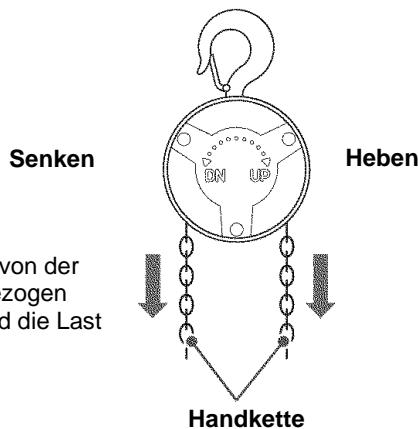
Wird die Handkette links bei Ansicht von der Radabdeckungsseite aus heruntergezogen (gegen den Uhrzeigersinn), dann wird die Last gesenkt.
