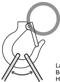
Lastaufhängung innerhalb eines Bereiches von 60° zu beiden Seiten der Hakenachse
