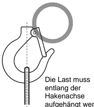
Die Last muss entlang der Hakenachse aufgehängt werden.
