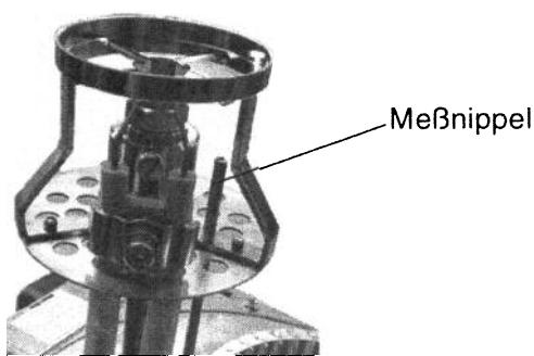
Zusammenbau in umgekehrter Reihenfolge. Dabei bei GG55 auf Position des Meßnippels achten (kleine Bohrung in der Stauscheibe, Kennzeichnung „M“).
