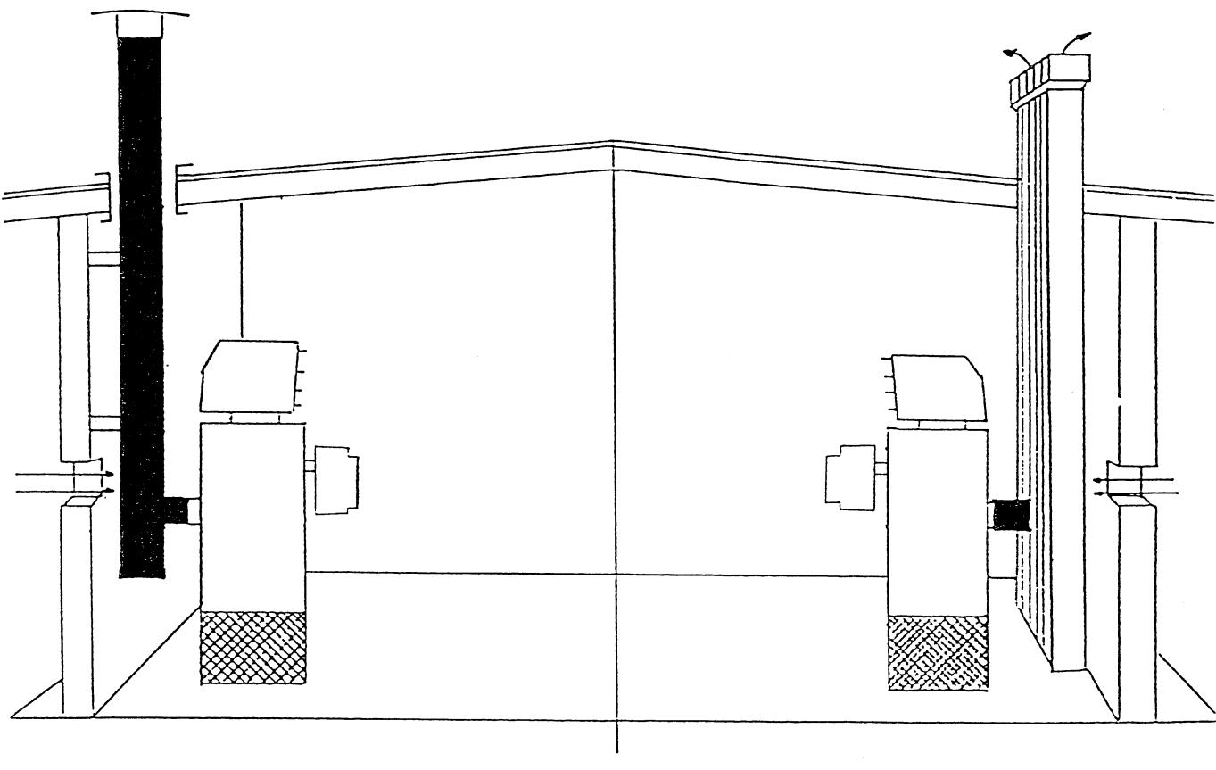
Das waagerecht verlegte Rauchrohr bis zum eigentlichen Kamin muß mit einer Steigung installiert werden.
