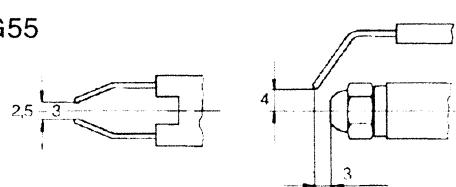
Die Elektroden sind werkseitig eingestellt.
