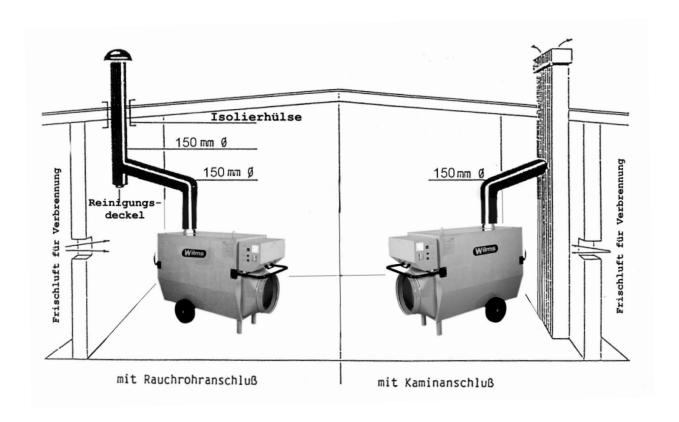
Das waagerecht verlegte Rauchrohr bis zum eigentlichen Kamin muß mit einer Steigung installiert werden.
