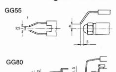
Die Elektroden sind werkseitig eingestellt. Die angegebenen Maße dienen zur Kontrolle.
