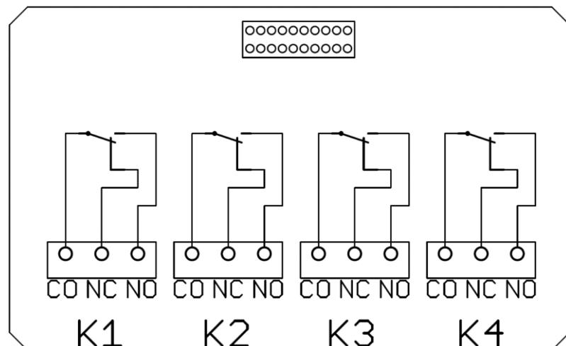
Der Anschlussplan zeigt das Relaismodul in spannungslosem Zustand.
