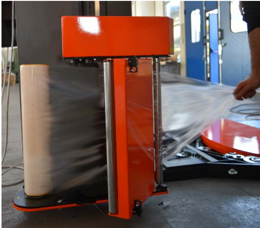
Phase 2-B: roller ein Folienende auf der Rolle aus Stahl, wie auf dem Bild ziehen.
