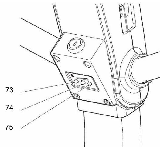
Das Blinken der roten Leuchte warnt davor, dass das Flurförderzeug kurz vor der Abschaltung steht. Die Batterie muss sofort geladen werden.
