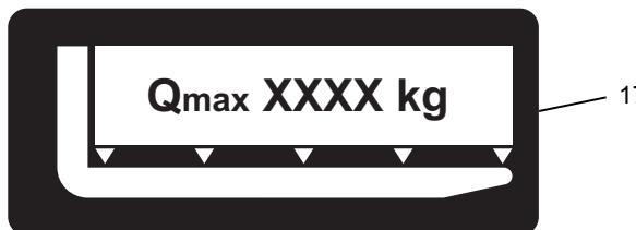
La targhetta della portata (17) indica la portata nominale massima Q (in kg) per un dato baricentro del carico C (in mm).
