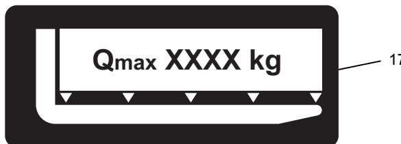
La plaque de capacité (17) indique la capacité Q (en kg) maximale pour un centre de charge C (en mm) donné.
