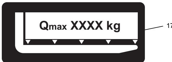
La placa de capacidades (17) indica la capacidad máxima Q (en kg) para un determinado centro de carga C (en mm).
