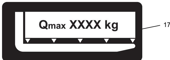
Das Tragfähigkeitsschild (17) gibt die maximale Tragfähigkeit Q (in kg) bei einem bestimmten Lastschwerpunkt C (in mm) an.
