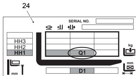
A placa de capacidade de carga (24) indica a carga nominal máxima Q (em kg) com uma determinada distância do centro de gravidade da carga D (em mm) e a respetiva altura de elevação H (em mm) do porta-paletes na recolha da carga.
