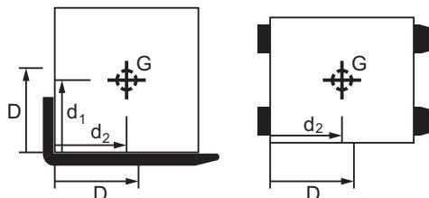
A distância do centro de gravidade da carga D do dispositivo de recolha de carga é indicada horizontalmente a partir do bordo dianteiro da parte traseira e verticalmente a partir do bordo superior do dispositivo de recolha de carga.
