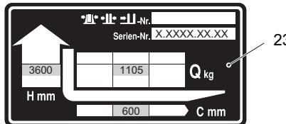
En el diagrama de cargas (23) se indica la capacidad de carga ( $Q$  en kg) con una determinada distancia al centro de gravedad de la carga ( $D$  en mm) y la correspondiente altura de elevación ( $H$  en mm) de la máquina al tomar la carga horizontalmente.
