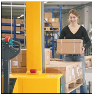
Verwendung als Hubtisch zur rückenschonenden Beladung
