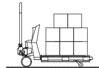
Korrektes heben der Last
