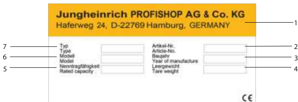
Ilust. 1: Placa de identificação (representação esquemática)
