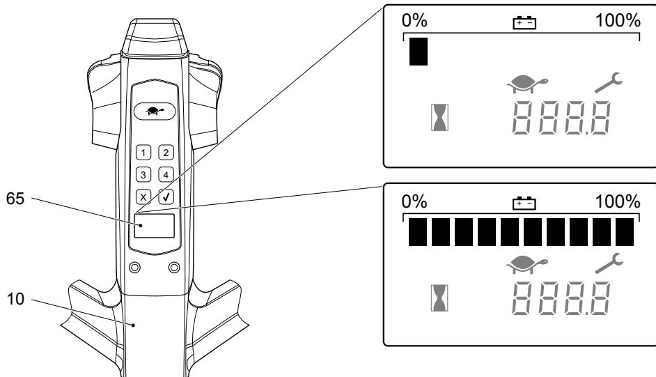
El indicador de estado de carga de la batería está integrado en la unidad de indicación (65) en la barra timón (10).
