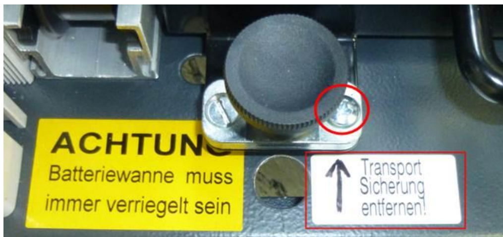
Obrázek 14 Výměnná vana s bateriemi - pojistka proti poškození během přepravy
