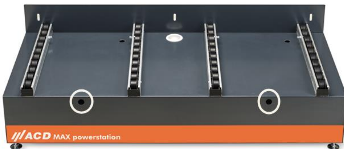
Obrázek 20 Index systému MAX powerstation k dokování mobilního pracoviště
