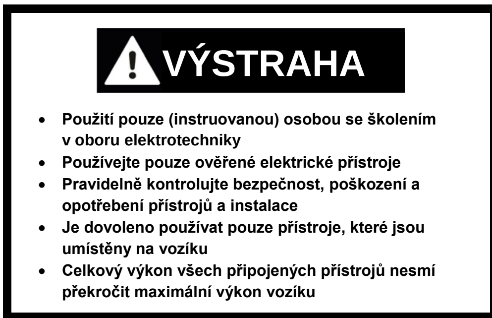
Obrázek 3 Výstražný štítek na vnitřním krytu mobilního pracoviště
