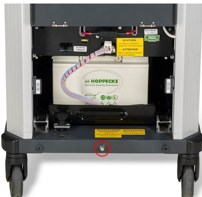
Obrázek 21 Index na mobilním pracovišti pro výměnu baterie pomocí stanice MAX powerstation.
