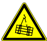
Werken onder hangende lasten
