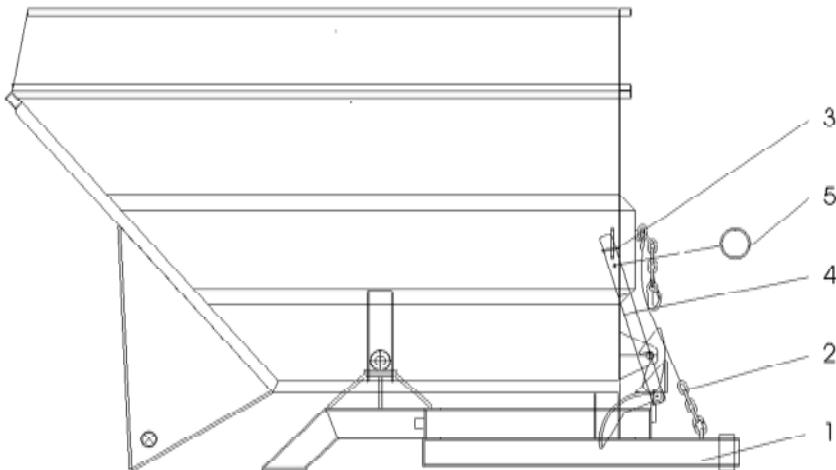
1. Rentrez dans les entrées du bac basculant (pos.1) avec les fourches du chariot élévateur.
