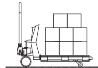
Korrekt lyftning av lasten
