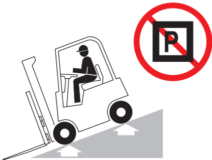
禁止坡上停车 Zákaz parkovania na rampe
