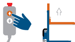
Imaginea 20 Apăsăți butonul de pe dispozitivul de control pentru a ridica transportorul.
