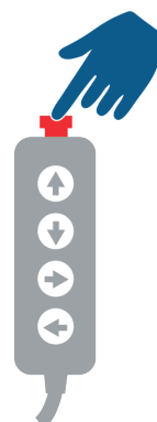
Figure 7 Activation des arrêts d'urgence.
