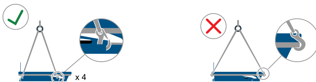
Figure 16 Ne pas soulever par le cadre de sécurité.
