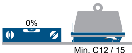
Bilde 17 Plasser armløfteren på et plant underlag med tilstrekkelig bæreevne.
