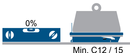
Imaginea 17 Amplasați platforma hidraulică cu picior articulat pe o bază orizontală, cu o capacitate portantă suficientă.
