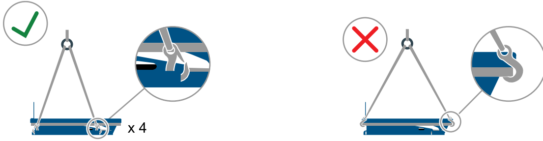
Resim 16 Güvenlik şasesinden kaldırmayın.
