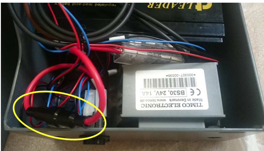
3. Abra o alojamento do fusível preto desaparafusando para substituir o fusível
