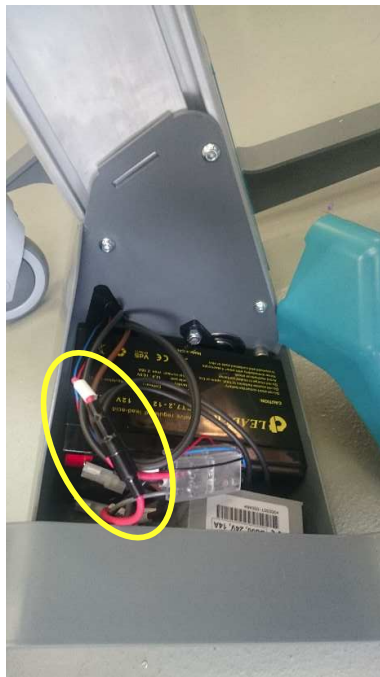
1. Verwijder de kunststof beschermkap voorzichtig 2. Zoek de zekeringkast op
