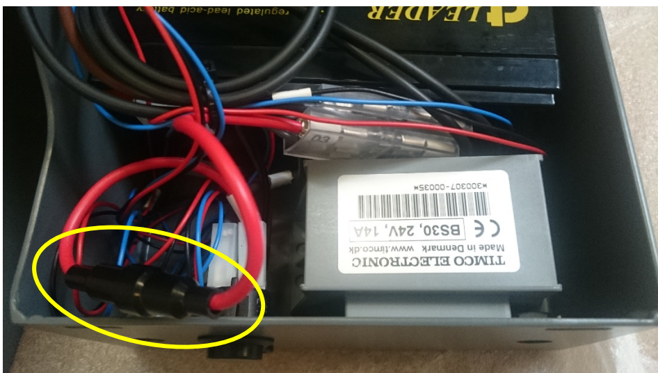
3. Öffnen Sie das schwarze Sicherungsgehäuse durch Herausdrehen, um die Sicherung auszutauschen.
