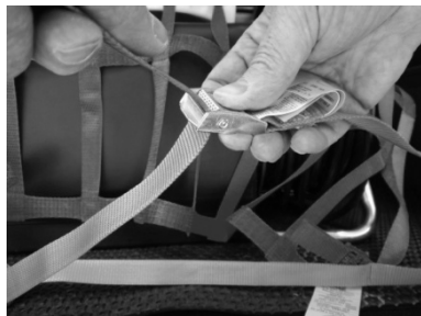
Bild 2: Anschließend Schnellspanner spannen. Lösen in umgekehrter Reihenfolge.
