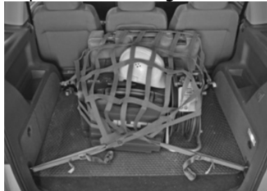
Bild 6: Schnellspanner verspannen. Die Ladung ist gesichert
