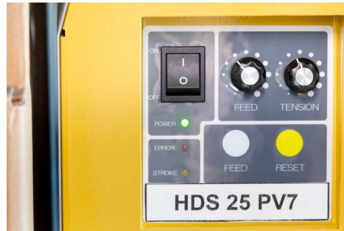
Flexible Einstellung von Bandvorschub und Bandspannung
