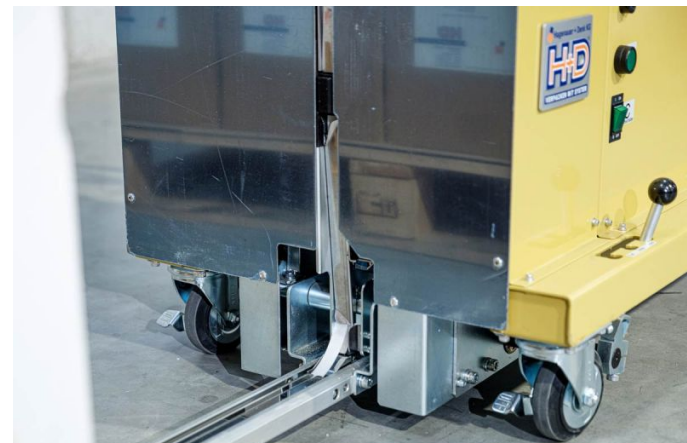
Zuverlässiger Bandtransport unter der Palette durch Klappensystem
