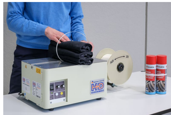
Für weiche Produkte kann die Bandspannung auf praktisch 0 reduziert werden.
