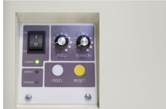
Über das Bedien-Panel können Bandspannung und Bandvorschub stufenlos eingestellt werden.
