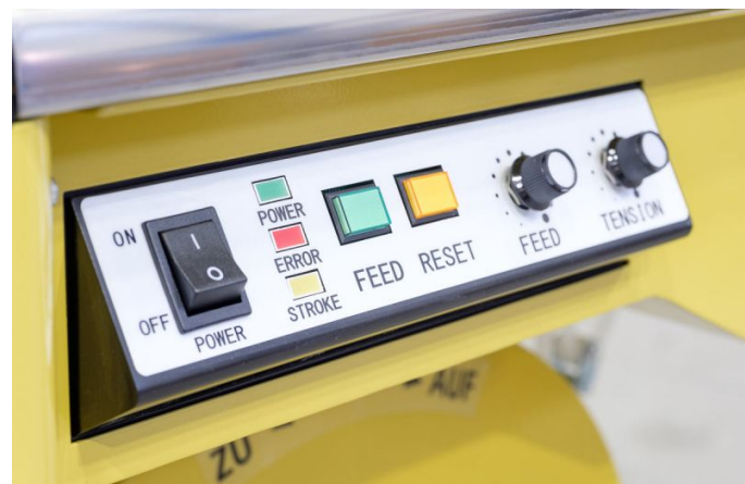
Übersichtliches Bedienpanel mit guter Zugänglichkeit.
