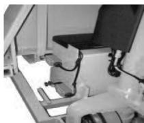
Um die Last weiter abzusenken muss vorerst am Bedienpanel auf "Off" gedrückt werden. Danach wird die Last mithilfe der manuellen Absenkfunktion an der Deichsel auf die gewünschte Höhe abgesenkt (siehe separate Beschreibung).
