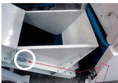
Verbinden Sie den Anschlussstecker des Förderbandes mit der Kupplung am Förderband.
