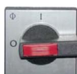
Drehen Sie bei Gefahr den Hauptschalter in Stellung „0“!
