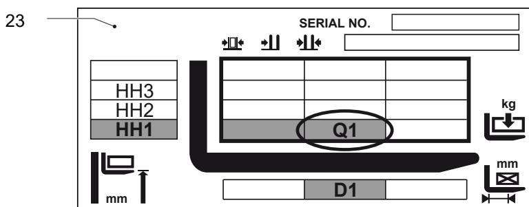
En la placa de capacidades de carga (23) se indica la capacidad de carga máxima Q (en kg) con una determinada distancia al centro de gravedad de la carga D (en mm) y la correspondiente altura de elevación H (en mm) de la carretilla elevadora al tomar la carga.
