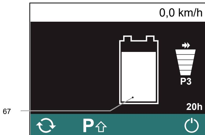
El estado de carga de la batería de iones de litio se indica en la pantalla del dispositivo de indicación (67). Además, en caso necesario, en la pantalla del dispositivo de indicación se muestran advertencias importantes sobre el estado de servicio de la batería de iones de litio (p. ej., estado de carga bajo, temperatura demasiado baja o demasiado alta), véase página 68.
