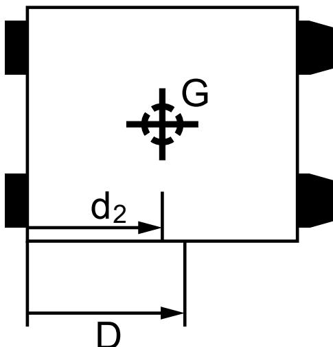
La distancia al centro de gravedad de la carga D del dispositivo tomacargas se indica horizontalmente desde el borde anterior de la pared trasera y verticalmente desde el borde superior del dispositivo tomacargas.
