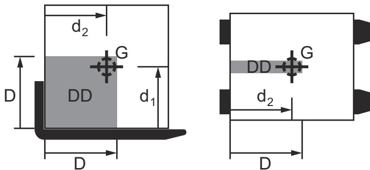
En las cargas con una distribución uniforme del peso el centro de gravedad de la carga está situado en el centro del volumen geométrico.
