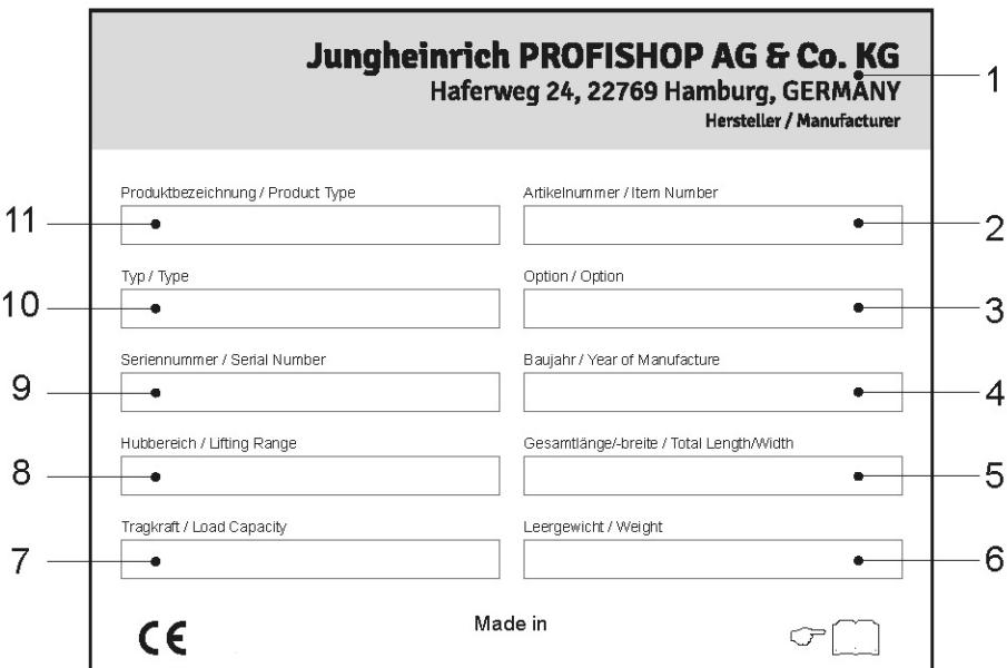
Illust. 1: Placa de identificação (representação esquemática)
