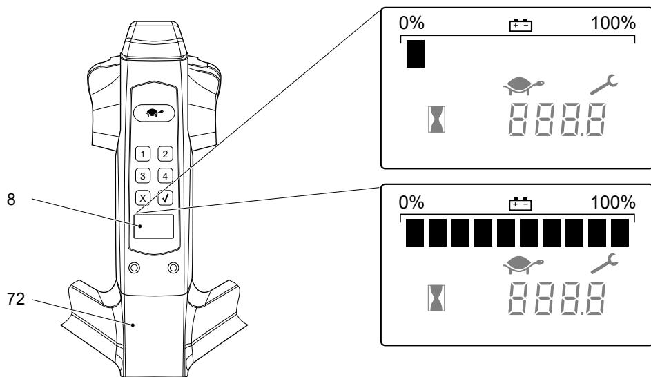
L'indicatore dello stato di carica della batteria è integrato nell'unità di segnalazione (8) presente sulla testata del timone (72).
