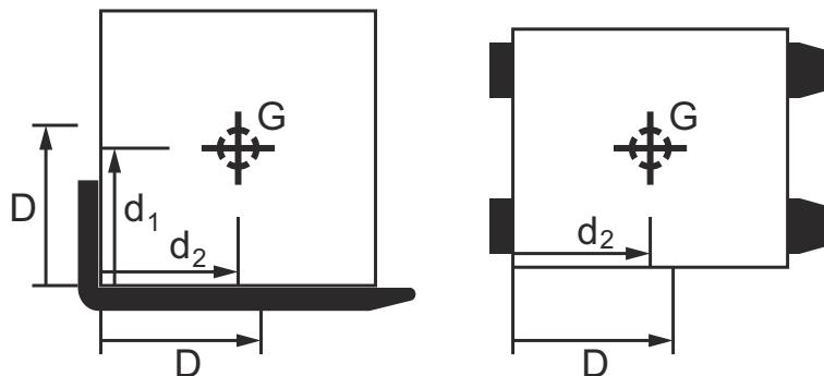
Der Lastschwerpunktabstand D des Lastaufnahmemittels wird horizontal von der Rückenvorderkante und vertikal von der Oberkante des Lastaufnahmemittels angegeben.
