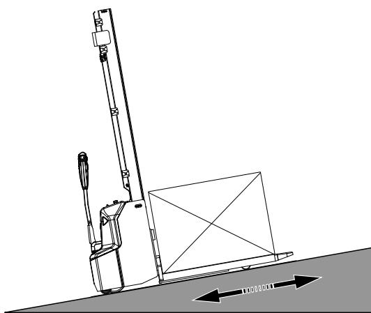
Bei Transportfahrt im Mitgänger-Betrieb muss das Lastaufnahmemittel, unabhängig von der Fahrtrichtung, bergseitig ausgerichtet sein.
