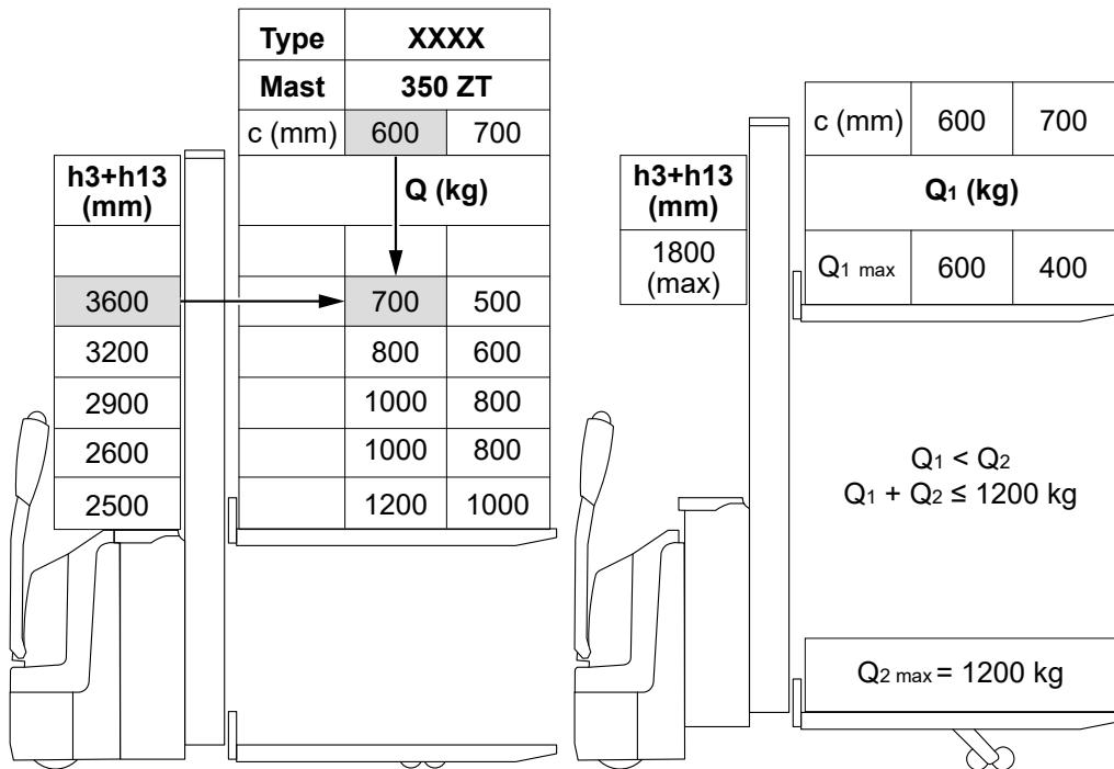
Das Tragfähigkeitsdiagramm gibt die maximale Tragfähigkeit  $Q$  [kg] des Flurförderzeugs für einen gegebenen Lastschwerpunkt  $c$  [mm] und die entsprechende Hubhöhe ( $h3+h13$ ) [mm] an.
