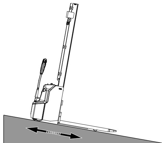
Bei Leerfahrt im Mitgänger-Betrieb kann das Lastaufnahmemittel, unabhängig von der Fahrtrichtung, talseitig ausgerichtet sein.
