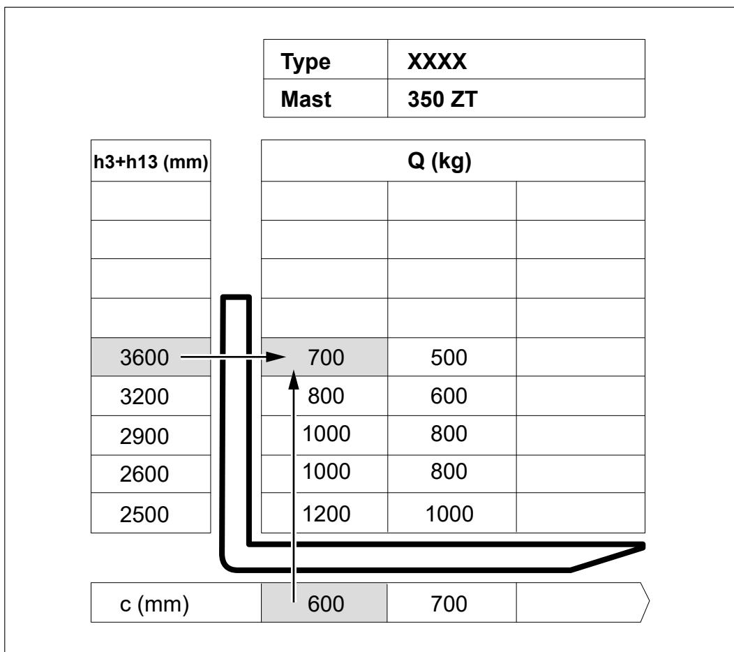
Das Tragfähigkeitsschild gibt die maximale Tragfähigkeit Q [kg] des Flurförderzeugs für einen gegebenen Lastschwerpunkt c [mm] und die entsprechende Hubhöhe (h3+h13) [mm] an.
