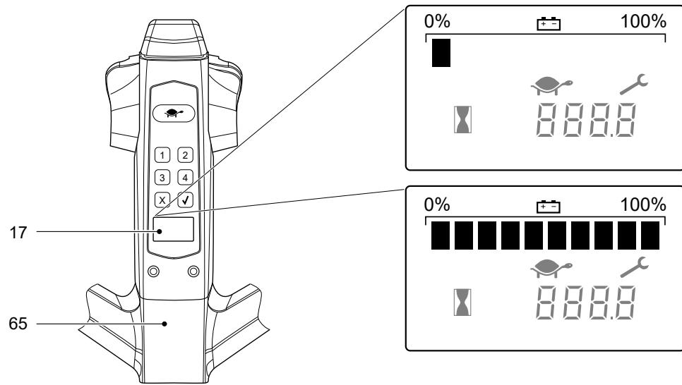
El indicador de estado de carga de la batería está integrado en el dispositivo indicación (17) del cabezal de la barra timón (65).
