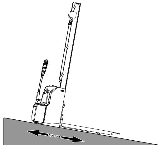
En el caso de marcha sin carga en servicio de conductor acompañante, el dispositivo tomacargas puede estar orientado cuesta abajo independientemente del sentido de marcha.
