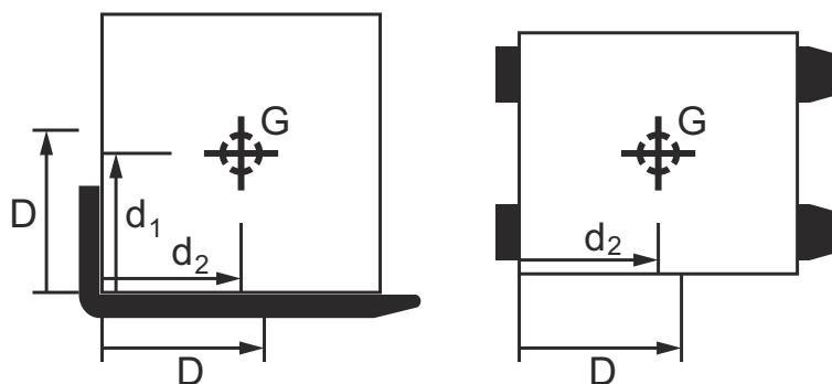
La distancia al centro de gravedad de la carga D del dispositivo tomacargas se indica horizontalmente desde el borde anterior de la pared trasera y verticalmente desde el borde superior del dispositivo tomacargas.
