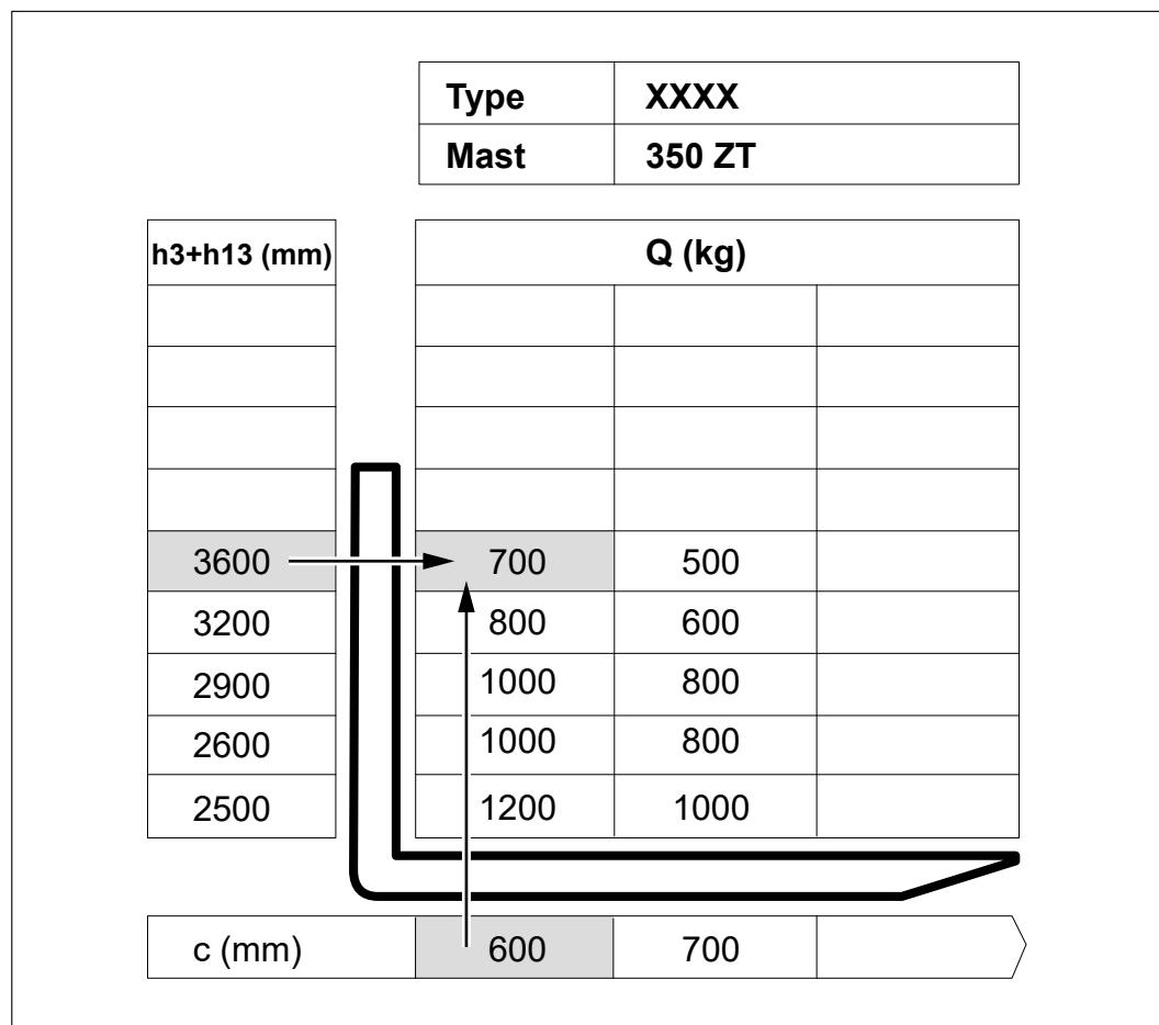
La placa de capacidades de carga indica la capacidad de carga máxima Q [kg] de la carretilla para un centro de gravedad de la carga concreto c [mm] y su correspondiente altura de elevación (h3+h13) [mm].
