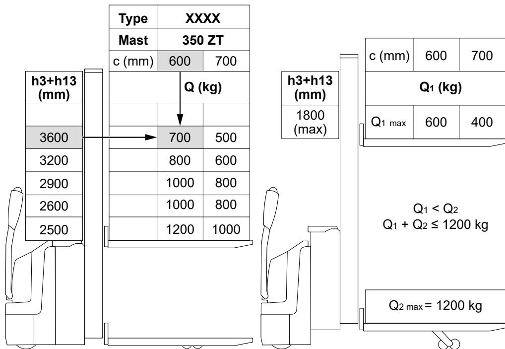
El diagrama de cargas indica la capacidad de carga máxima Q [kg] de la carretilla para un centro de gravedad de la carga concreto c [mm] y su correspondiente altura de elevación (h3+h13) [mm].
