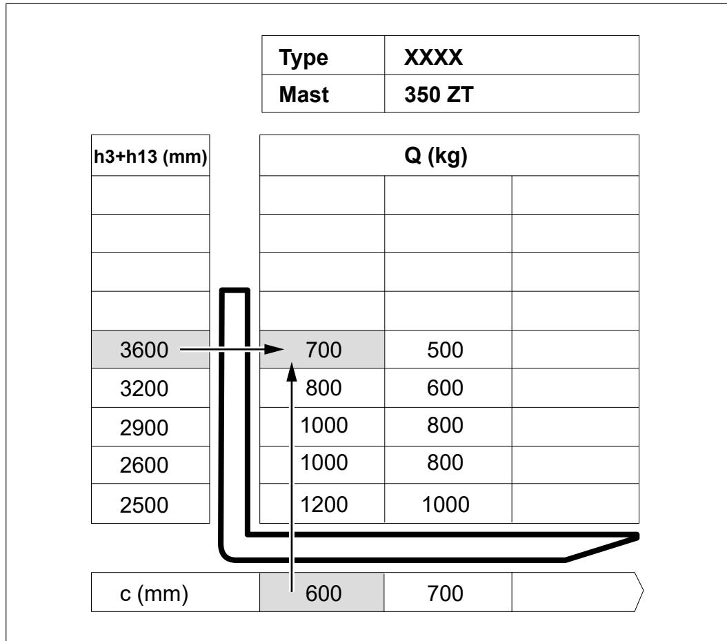
La plaque de capacité de charge indique la capacité de charge maximale Q [kg] du chariot pour un centre de gravité défini de la charge c [mm] et sa hauteur d'élévation correspondante (h3+h13) [mm].
