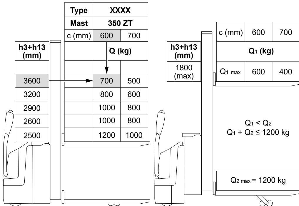
Le diagramme de charge indique la capacité nominale maximale  $Q$  [kg] du chariot pour un centre de gravité défini de la charge  $c$  [mm] et sa hauteur d'élévation correspondante ( $h_3 + h_{13}$ ) [mm].
