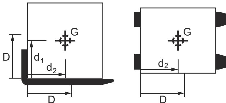
La distance du centre de gravité de la charge D du dispositif de prise de charge est indiquée dans le sens horizontal depuis le bord avant du talon et dans le sens vertical à partir du bord supérieur du dispositif de prise de charge.
