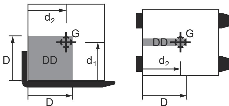
Avec des charges au poids uniformément réparti, le centre de gravité de la charge se situe au point central géométrique.
