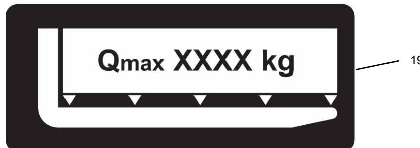
Das Tragfähigkeitsschild (19) gibt die maximale Tragfähigkeit Q (in kg) bei einem bestimmten Lastschwerpunkt C (in mm) an.
