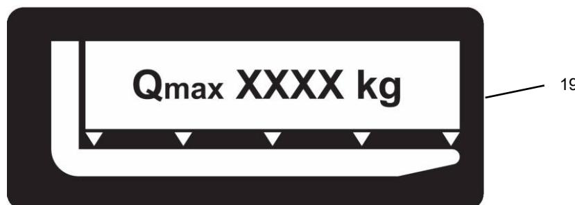
La placa de capacidades (19) indica la capacidad máxima Q (en kg) para un determinado centro de carga C (en mm).
