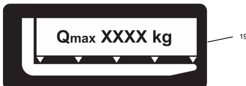
La plaque de capacité (19) indique la capacité Q (en kg) maximale pour un centre de charge C (en mm) donné.
