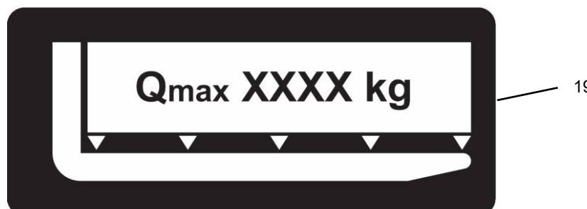
La targhetta della portata (19) indica la portata nominale massima Q (in kg) per un dato baricentro del carico C (in mm).
